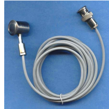
Obr.3: Piezokeramický snímač AE s vestavěným předzesilovačem.
